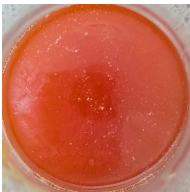
Figura 25. Formación de jabones por neutralización del aceite de tilapia
