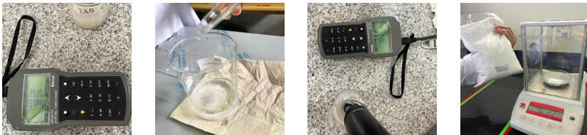
Figura 7. Medición inicial de pH, preparación de la solución acidificante, medición posterior al proceso de acidificación y adición de conservantes como benzoato de sodio..
