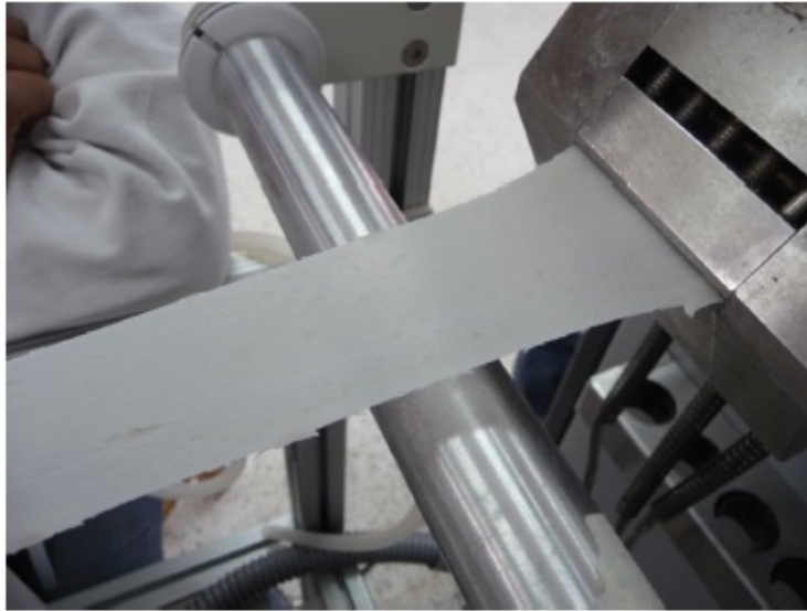
Figura 4.1 Película flexible a partir de almidón de yuca obtenida por extrusión
