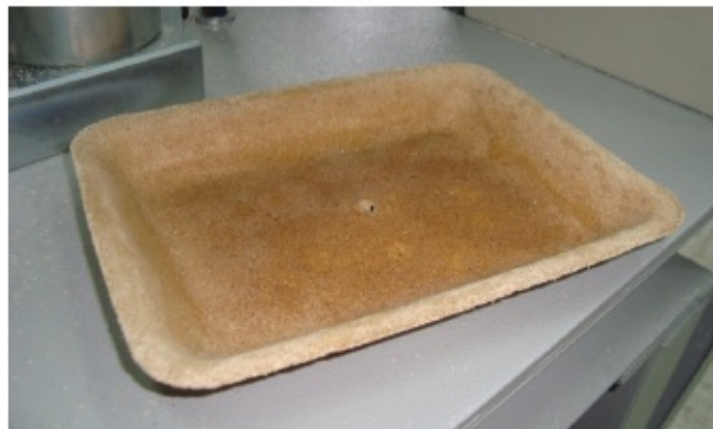
Figura 4.2 Bandeja semirrígida a partir de harina de yuca obtenida por termocompresión
